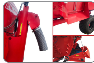
DESCARGA POR PVC, GRAVEDAD O SINFÍN
